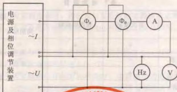
图 1 直接比较法的线路图
