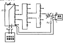
图 6 用多挡分压箱检定 DVM
